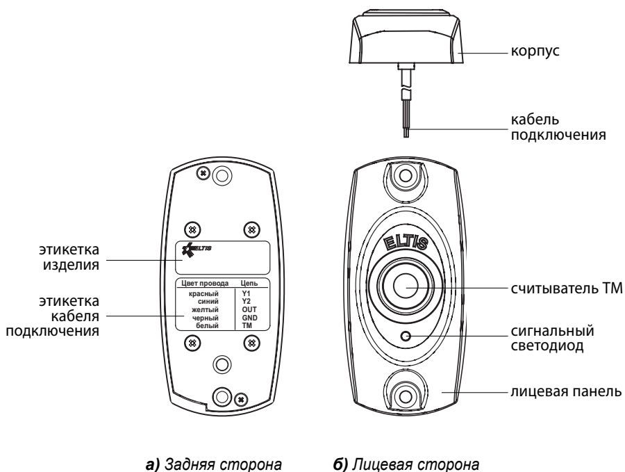
Рис.1 Внешний вид блока электронного ключевого устройства CRT-51
